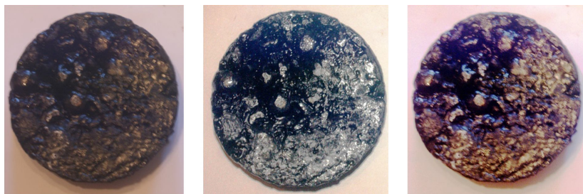
а б в Рис. 3. Образец дорожного покрытия (гранит мелкий) при различных видах отражения света
