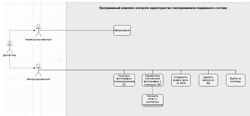
Рис. 2. Функционал программного комплекса модели системы контроля характеристик токоприемников подвижного состава
