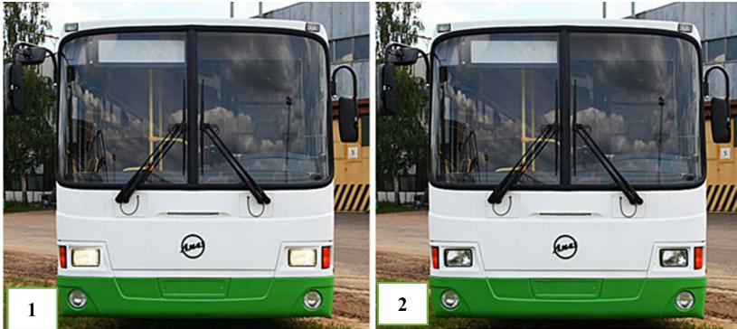
Рис. 3. Определение работоспособности фар по параметрам RGB:
