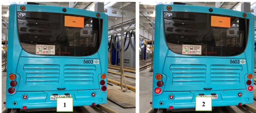
Рис. 2. Определение работоспособности стоп-сигналов автобуса по цветовым характеристикам RGB:
