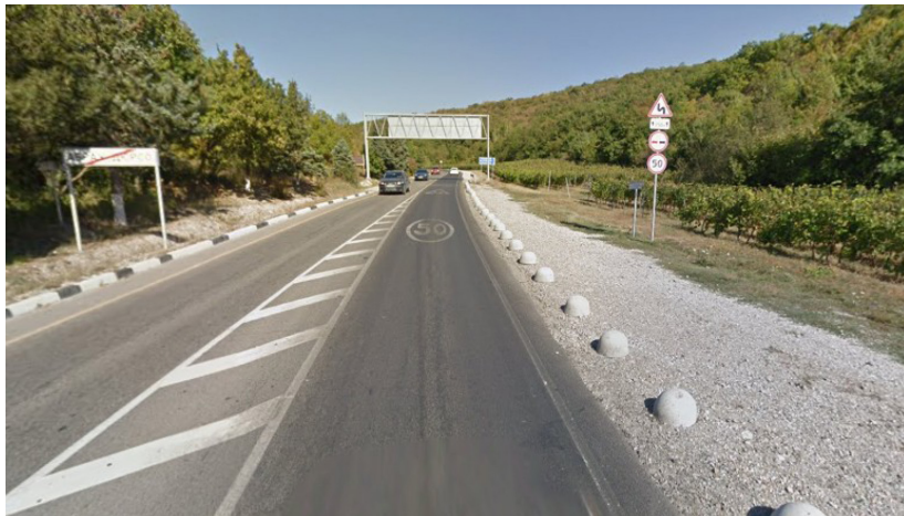
Рис. 11. Пример применения концепции «forgiving road side design» в Краснодарском крае
