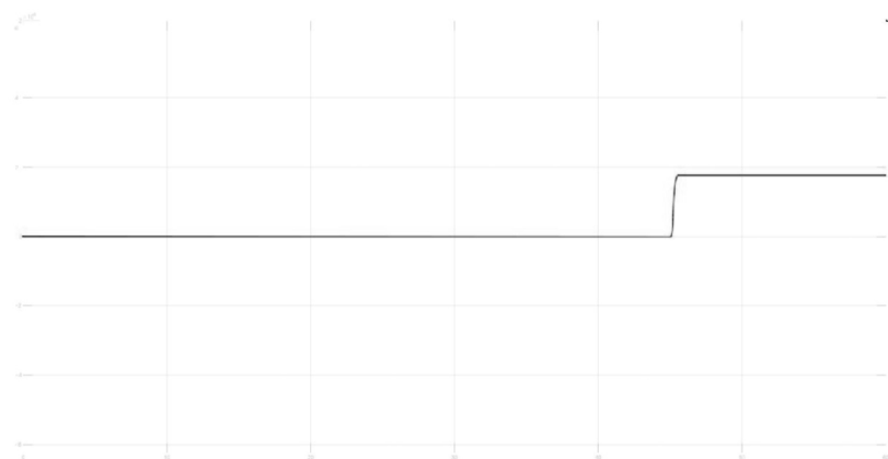
Рис. 12. Изменение давления в цилиндре механизма разворота кабины
