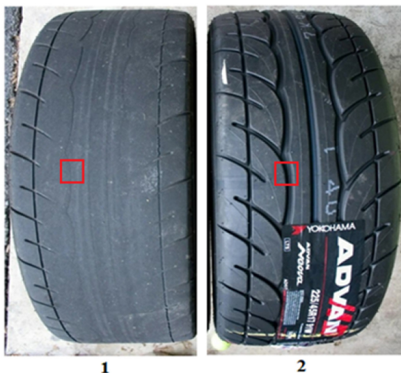
Рис. 6. Определение цветовых характеристик шин: 1 – Шина с износом: Red \approx 106 , Green \approx 119 , Blue \approx 136 ; 2 – Шина без износа: Red \approx 59 , Green \approx 72 , Blue \approx 81 .
