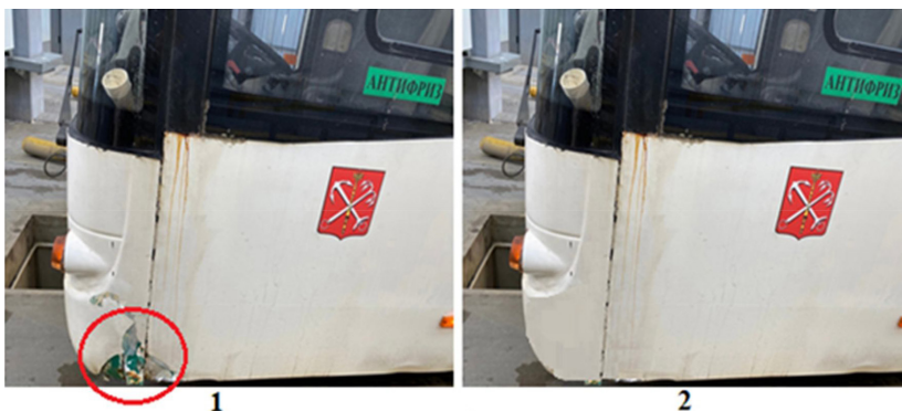
Рис. 4. Определение поврежденных зон кузова автобуса по параметрам цветовых характеристик RGB:
