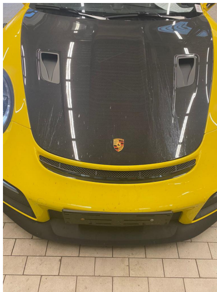
Рис. 2. Углепластиковые бампер и капот
