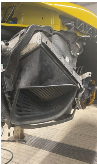
Рис. 5. Корпус интеркулера из углепластика.
