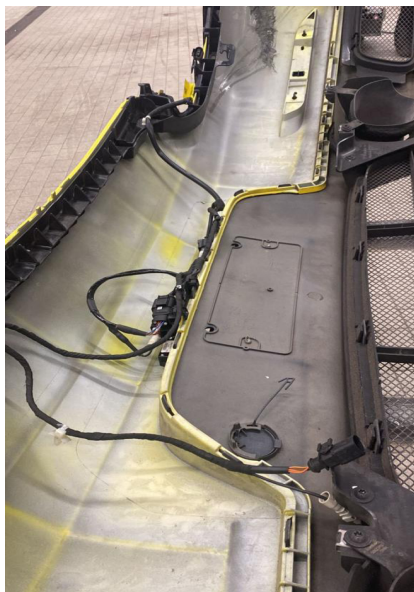
Рис. 4. Бампер из полиуретана изнутри
