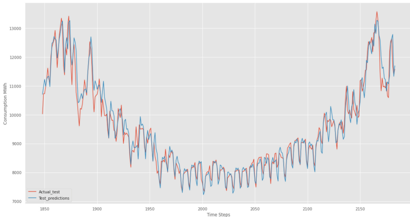
Рис. 2. Прогнозирование энергопотребления с использованием тестовой выборки
